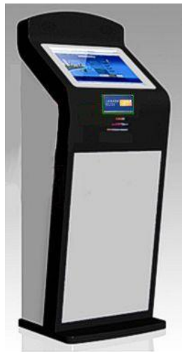
Фиг. 1. Външен вид на устройство за продажба на билети TIDS, монтирано в превозното средство
